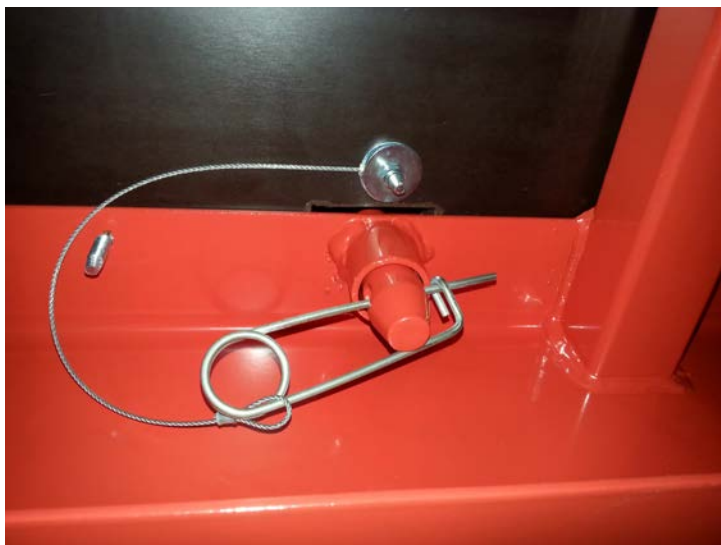
Șplinturi la platformă
